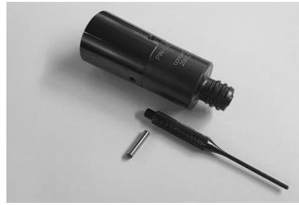
BILZ Präzisions-Spannhülsen mit Auszugssicherung sind für die Schwer-Zerspanung entwickelt und spannen alle Werkzeugschäfte mit Weldonfläche nach DIN 1835-B und DIN 6535-HB formschlüssig mittels einem Verriegelungspin. The BILZ precision collet with mechanical pull stop was especially developed for heavy roughing applications. It locks tool shanks with Weldon-surface according to DIN 1835-B and DIN 6535 HB by using a locking-pin.
