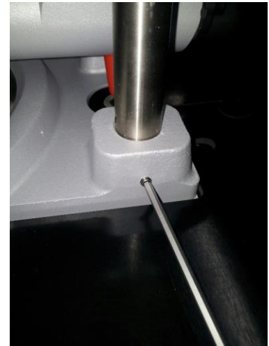
Fig. 7 Fastening of the PE screws
