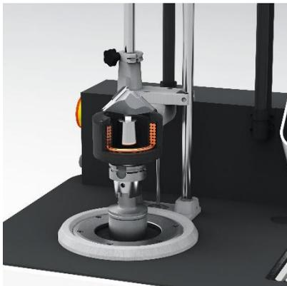
Bringen Sie den Spulenanschlag an der Führungsstange über der Spule an. Schieben Sie die Spule manuell nach oben, bis sie sich in Schrumpfposition zum Spannfutter befindet.
