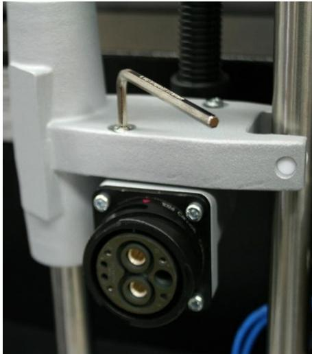
Die Steckereinheit zusammen mit dem Kabelschlepp an der Schlitteneinheit mit den zwei beiliegenden Schrauben befestigen (DIN912 M5x20, siehe Abbildung 9).
