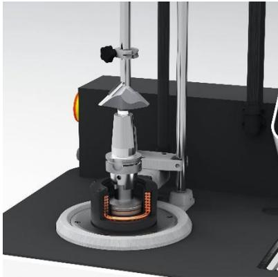
Zum Ausschumpfen eines Werkzeugs setzen Sie bei eingeschaltetem Gerät und ausgewählter Option **Invers** (Spule befindet sich in der unteren Endposition des Zylinders) das Spannfutter in die passende Werkzeugaufnahme.
