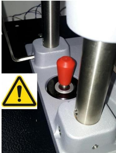
Die vormontierte Führungseinheit in die Aufnahmebohrung stellen und mit den zwei beiliegenden Schrauben (DIN912 M6x20) befestigen (Abbildung 5).
