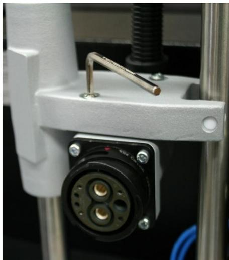
Die Steckereinheit zusammen mit dem Kabelschlepp an der Schlitteneinheit mit den zwei beiliegenden Schrauben befestigen (DIN912 M5x20, siehe Abbildung 7).
