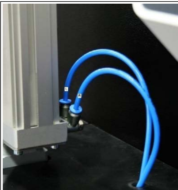
Abbildung 4: Anschließen der Druckluftleitungen an der Lineareinheit
