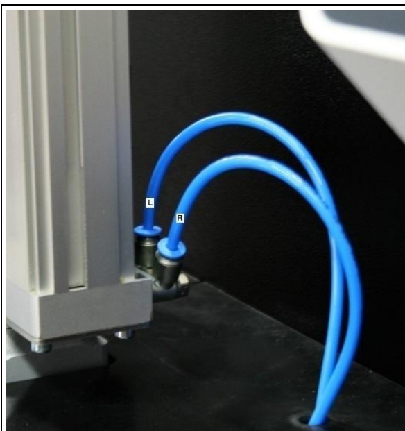
Abbildung 4: Anschließen der Druckluftleitungen an der Lineareinheit
